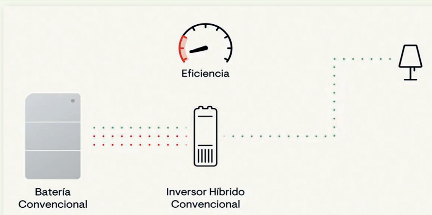
Figura 2: Funcionamiento de un inversor híbrido convencional a baja carga
