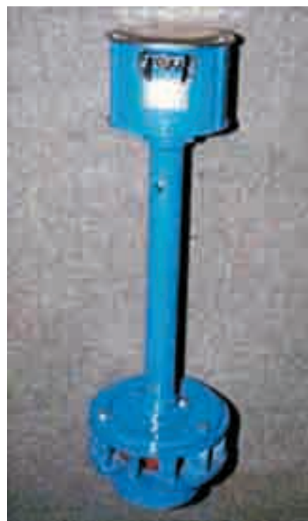
Debajo de la turbina, que tiene esta curiosa forma de pesa de gimnasio, debe ir siempre un tubo de desagüe de 1,5 metros de altura.
