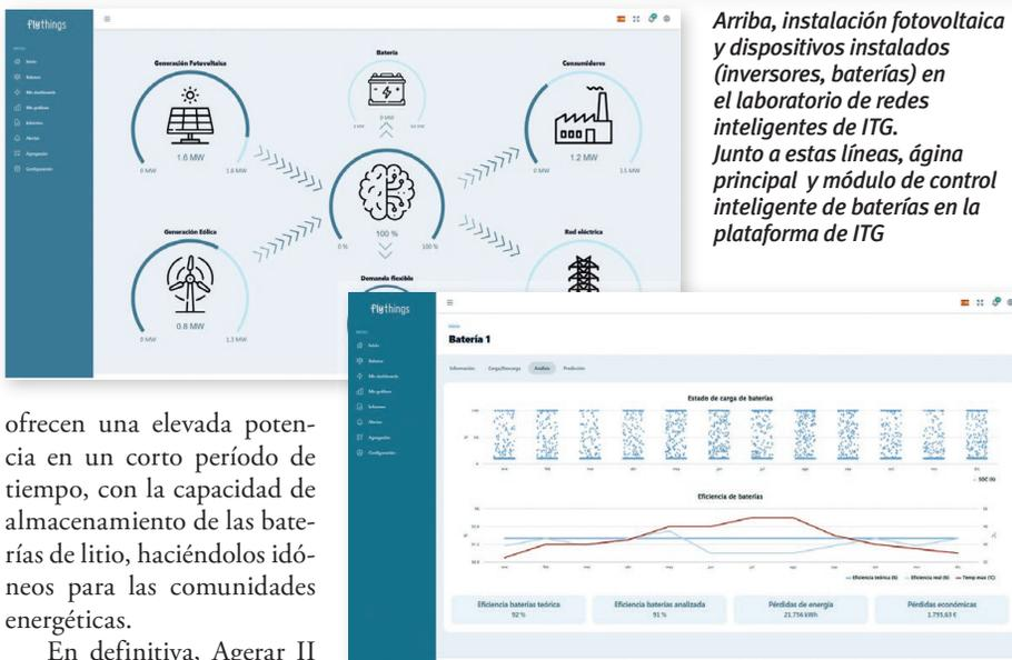
Arriba, instalación fotovoltaica y dispositivos instalados (inversores, baterías) en el laboratorio de redes inteligentes de ITG. Junto a estas líneas, ágna principal y módulo de control inteligente de baterías en la plataforma de ITG
