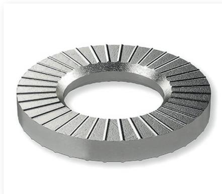
El efecto de fijación fiable se consigue a través de los nervios radiales que hacen presión sobre el material durante la unión. Las arandelas RIPP LOCK® garantizan la conservación permanente de la fuerza de precarga en la unión atornillada, incluso en el caso de cargas dinámicas altas. Asimismo, permiten varias reutilizaciones y son
