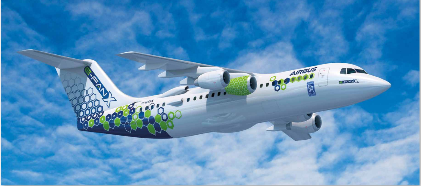
En la imagen, Airbus E-Fan X. Uno de los cuatro motores a reacción de este prototipo, lanzado por la compañía aérea en 2017, es eléctrico
