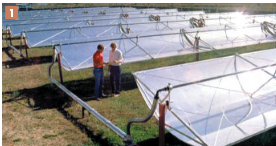
A la derecha, concentradores solares cilindro-parabólicos, la tecnología más desarrollada hasta el momento para la producción de electricidad.
