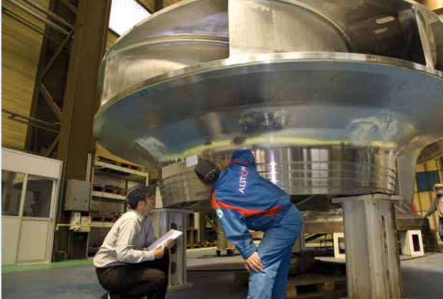
En página anterior, embalse de Linthal en Suiza donde se va a construir una de las centrales de bombeo reversible más avanzadas. Arriba, primer plano de una Alstom Pump turbine y, abajo, turbina de doble etapa.
