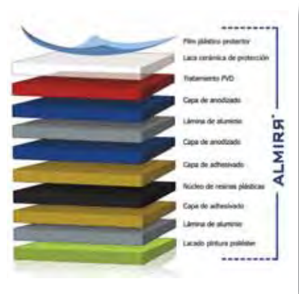
Arriba, el espejo multilaminar Almir, capa a capa. A la izquierda, imagen del interior de la fábrica de Alucoil en Miranda de Ebro.
