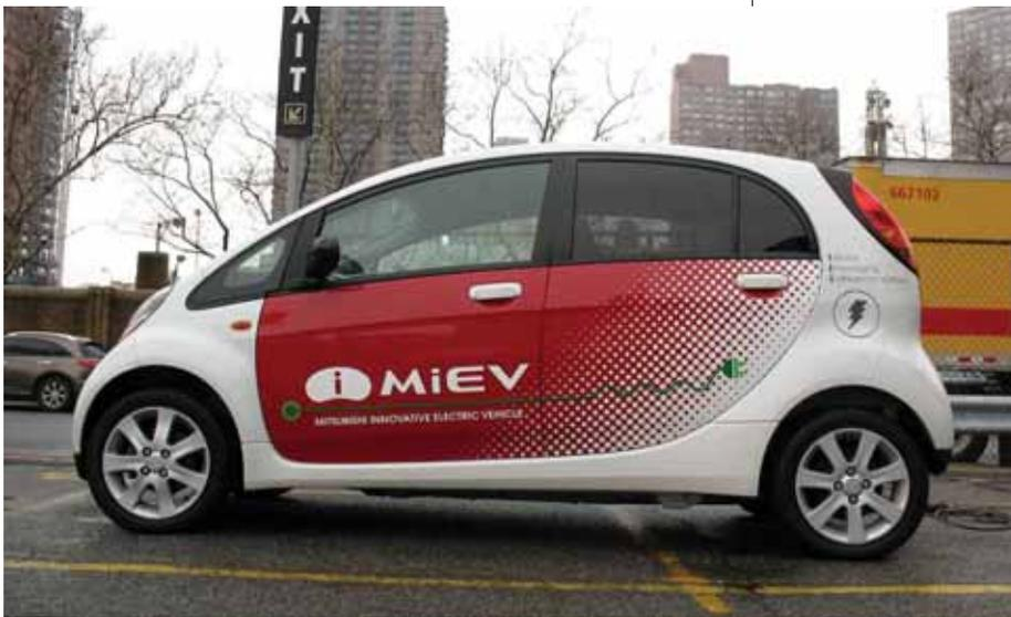
para aumentar la autonomía y “B”, otra novedad presente en el i-MiEV con la que se consigue aumentar el freno motor al levantar el pie del acelerador y potenciar así la recarga de las baterías. Muy útil para el descenso de pendientes y para la optimización de la energía. En una conducción en ciudad podría resultar un poco brusco pero en carretera es muy útil. Se favorece el confort y el rendimiento, y todo es seleccionable por el conductor, una gran idea.
