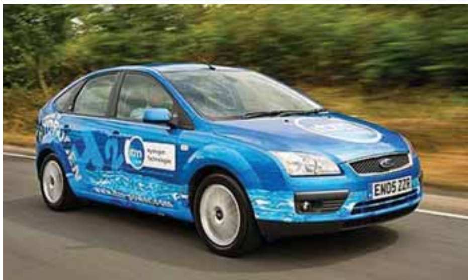
El Ford Focus bi-fuel puede usar indistintamente hidrógeno y gasolina sin tener que detener el vehículo. Ambos combustibles se queman en un motor térmico.
