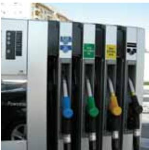
“**L**os Ángeles” comercializa bioetanol mezclado con gasolina en distintos porcentajes: 5 por ciento de bioetanol (e5), 10 por ciento de bioetanol (e10) y 85 por ciento de bioetanol (e85). Los surtidores cuentan con un dispositivo automático -blenders-, que permite elegir la mezcla en el momento de repostar.
