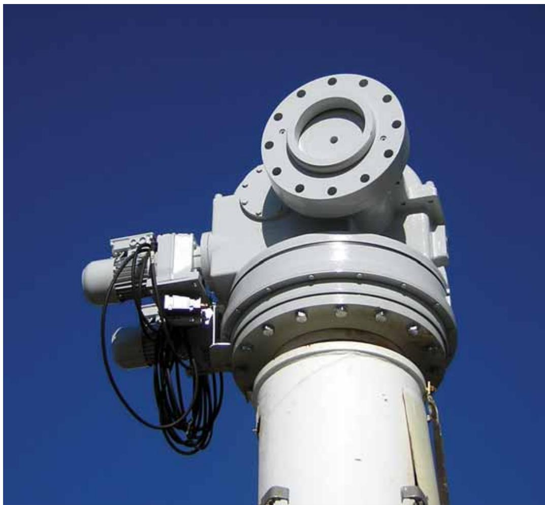
*Los helióstatos disponen de un mecanismo que posiciona con precisión la superficie de los espejos, de forma que en cada momento del día la energía solar se proyecta sobre el receptor, minimizándose las pérdidas de energía por desbordamiento.*
