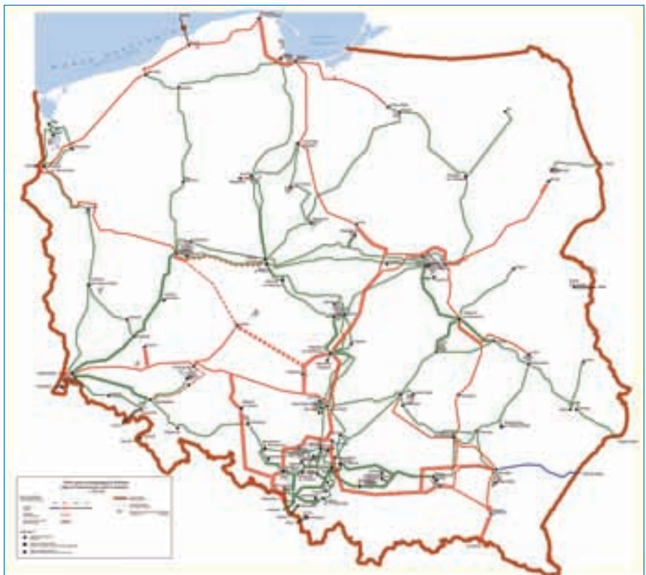
Las dos fotos son del parque eólico de Tymień, de 50 MW, puesto en marcha en 2006. El mapa dibuja la red eléctrica de Polonia, que no permitirá la conexión de más de 1.500 MW eólicos en los próximos cinco años.
