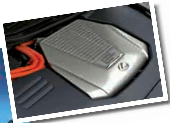
evitando que alcance valores extremos elevados o reducidos, supervisa la velocidad de carga y descarga y convierte la energía continua en alterna a la vez que aumenta el voltaje a los 650 V con los que funciona el motor. Su ubicación es la causante del mayor defecto del Lexus GS 450h, la escasez de maletero, ya que sólo homologa 280 litros frente a los 430 del GS normal lo que le sitúa a la altura de algunos utilitarios.
