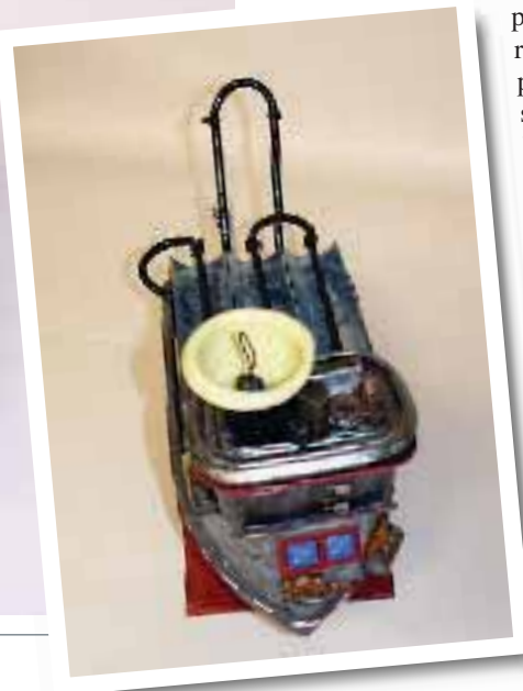
BARCO STEAMER, propulsado por el chorro generado por el vapor de un líquido que evapora a 40°, con triple captador de energía solar cilíndrico-parabólico.
