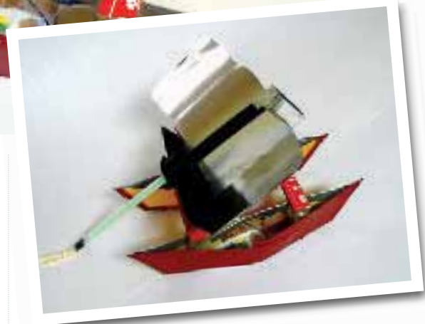
CATAMARÁN POP-POP , propulsado por un motor de vapor de agua estático con diafragma (también llamado pop-pop por el sonido que produce), con captador de energía solar cilíndrico-parabólico regulable.
