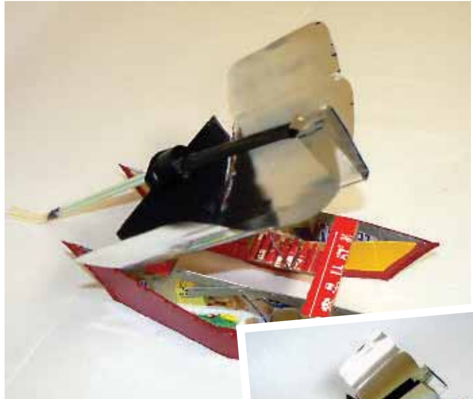
CATAMARÁN POP-POP , propulsado por un motor de vapor de agua estático con diafragma (también llamado pop-pop por el sonido que produce), con captador de energía solar cilíndrico-parabólico regulable.
