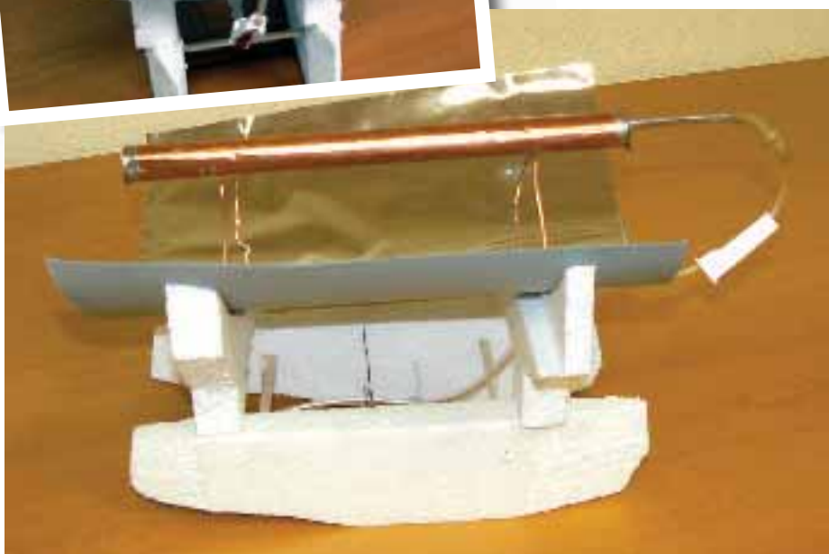
CATAMARÁN ARGOS , propulsado por un motor de vapor de energía solar cilíndrico-parabólico y tubo colector cilíndrico.
