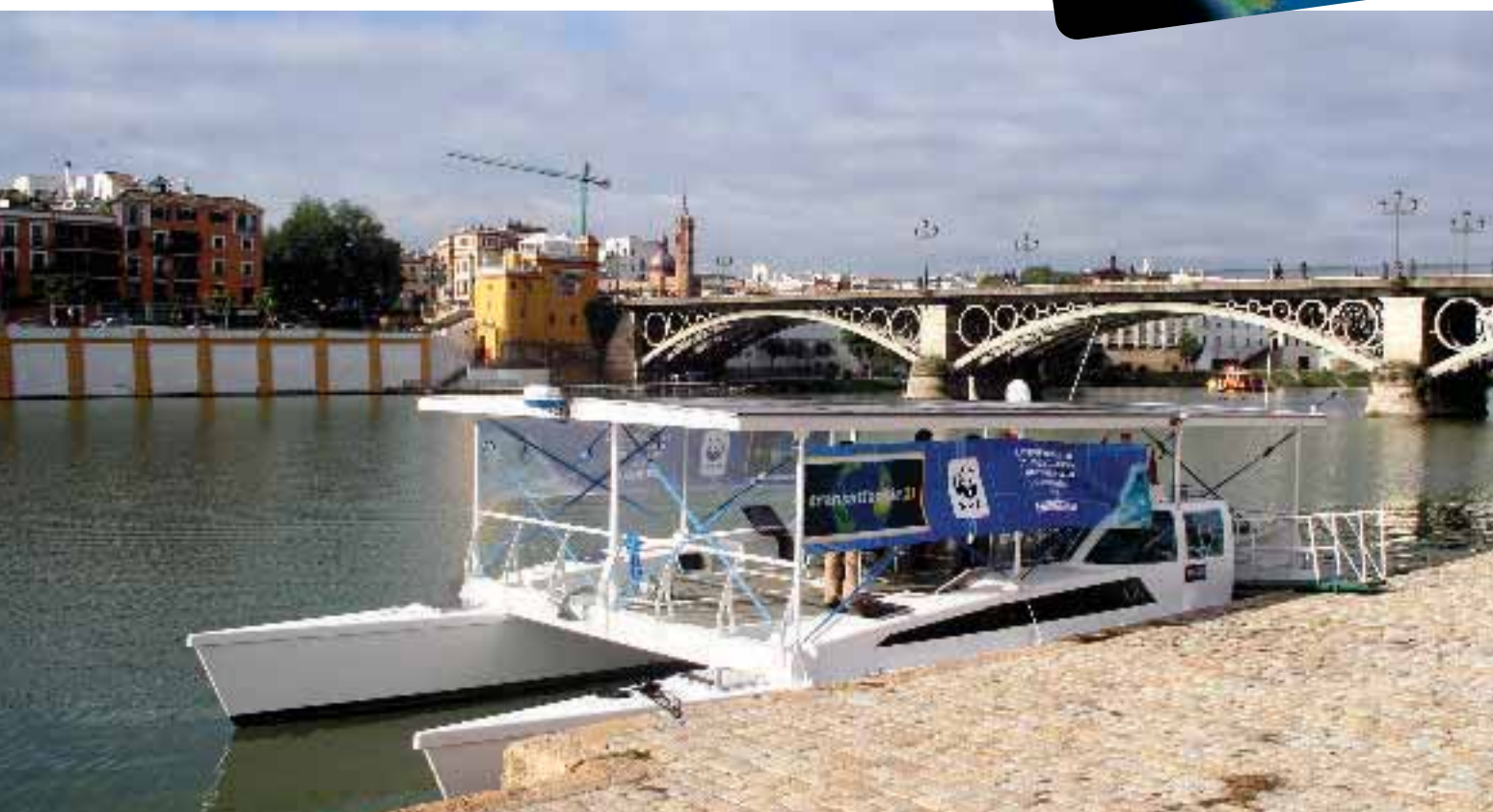
El catamarán Sun21 mide 14 metros de eslora y 6,5 de manga. Navega gracias a dos motores eléctricos, de 8 kW, alimentados por las baterías donde se almacena la electricidad generada por la energía solar.
