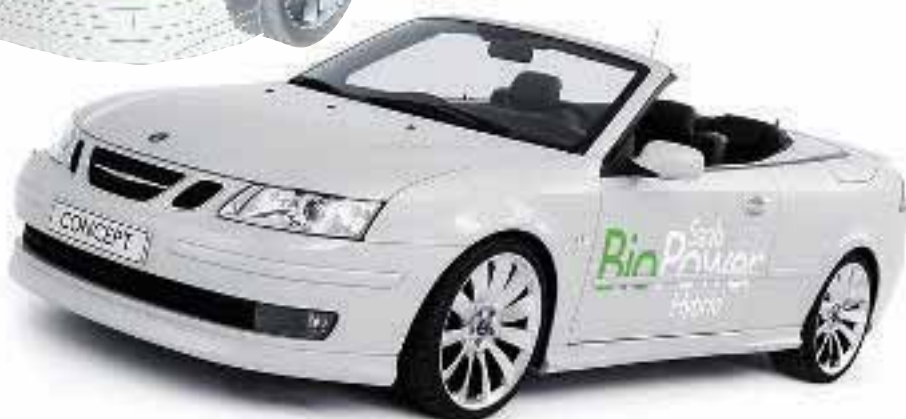
El BioPower Hybrid puede funcionar con E100 (etanol puro), E85, gasolina u otra mezcla de gasolina/etanol.
