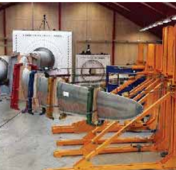
Prueba de resistencia de una pala en Impsa Wind.
