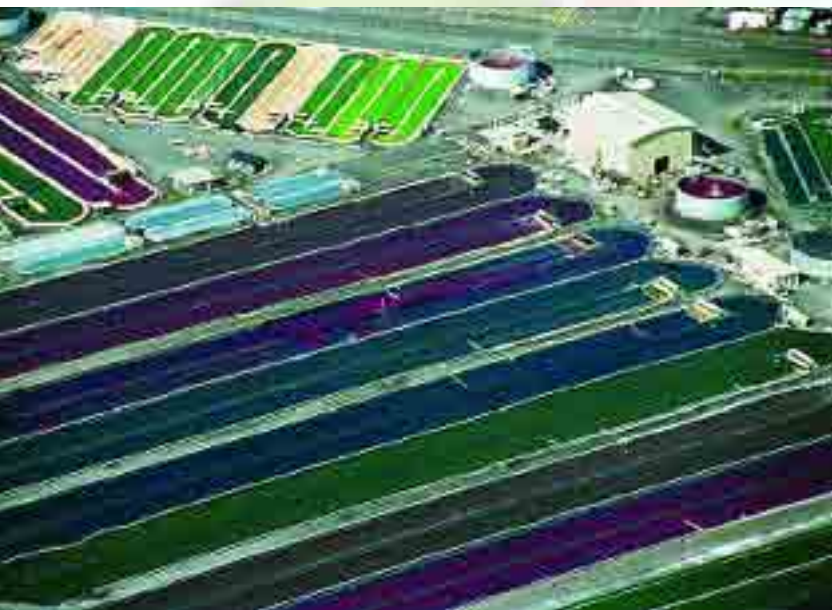
Estanques de cultivo de algas. En verde los de Spirulina y en rojo los de la especie Haematococcus pluvialis . Foto de International Network on Biofixation of CO 2 and Greenhouse Gas Abatement with Microalgae.
