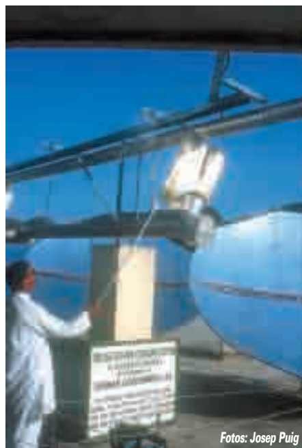
Estos espejos permiten usar el sol para cocinar en la India. En la foto superior, la cocina solar en Gyan Sarovar, con 24 parábolas. La de la izquierda es la cocina más grande del mundo: está en Shantivan y tiene 84 parábolas alineadas de dos en dos. En la imagen de la derecha, se señala el punto donde convergen dos haces de rayos de los espejos alineados.
