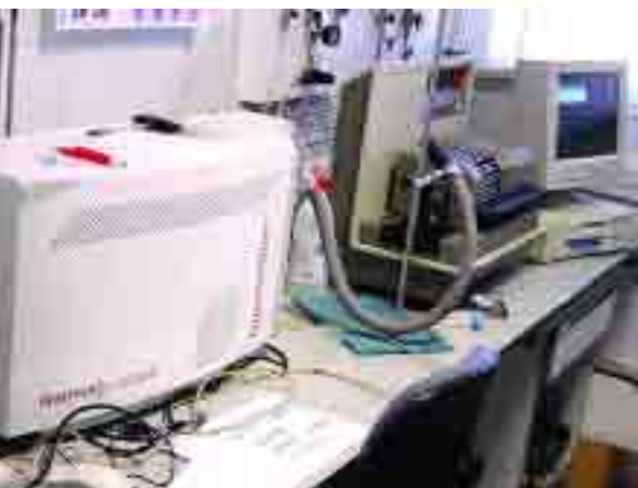
Los reactores anaerobios se utilizan en el proceso de obtención del biogás. Abajo, con la espectrometría de masas acoplada a termobalanza se hace una evaluación del grado de estabilización del residuo.
