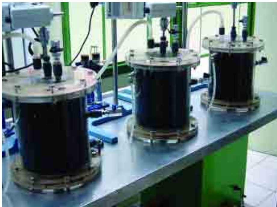
Los reactores anaerobios se utilizan en el proceso de obtención del biogás. Abajo, con la espectrometría de masas acoplada a termobalanza se hace una evaluación del grado de estabilización del residuo.
