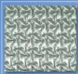
Utiliza el revolucionario absorbedor DTE (Directa Transferencia de Energía), patentado por Soleco, realizado mediante dos planchas de acero inoxidable de 0,6 mm soldadas por láser y conformadas por presión (hidroforming). Toda la superficie absorbadora está en contacto directo con el fluido caloportador.
