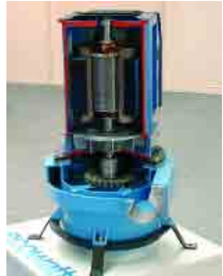
Microturbinas de Saltos del Pirineo, manufacturadas por THEE
