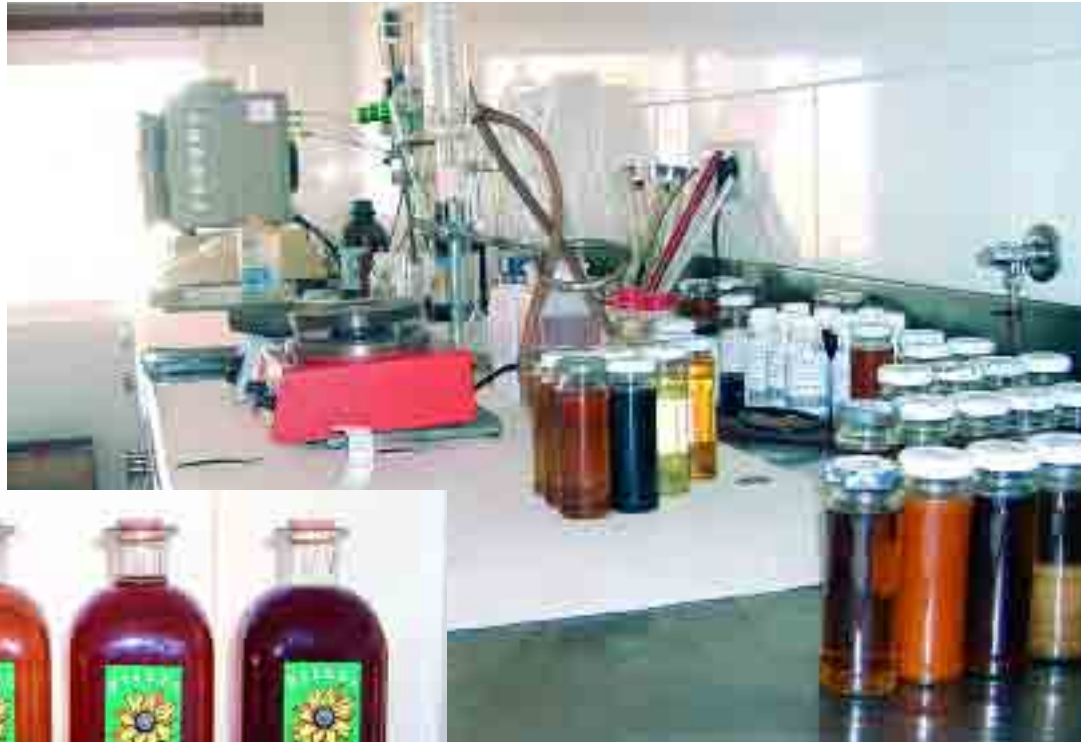
La elaboración del biodiesel exige una serie de procesos en los que se decanta, filtra y depura el aceite, hasta que el nuevo producto está disponible para su uso en los motores
