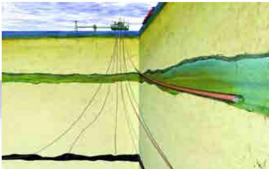
Recreación de una de las posibilidades que se contemplan para inyectar el CO 2 en el subsuelo terrestre, en este caso en un acuífero salino debajo de un campo de gas natural en el Mar del Norte. Foto: Statoil.
