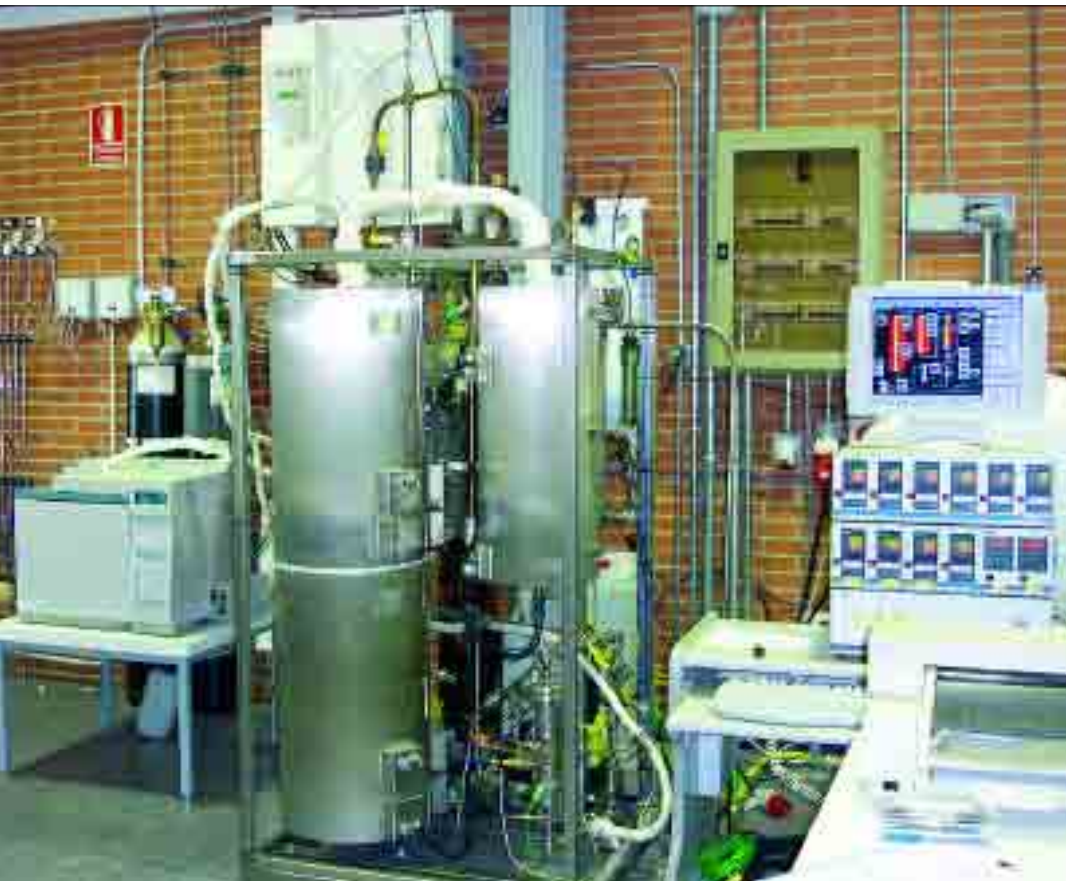
Procesador de bioetanol de 10 kW desarrollado por Abengoa y el Grupo de Pila de Combustible del Instituto de Catálisis y Petroleoquímica del Consejo Superior de Investigaciones Científicas (CSIC-ICP).
