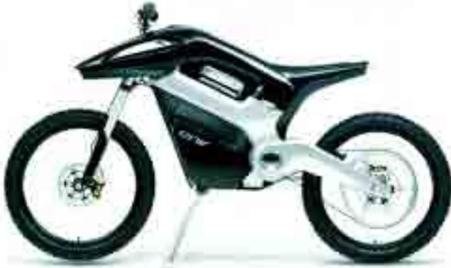
**A**ccionada con una pila combustible de hidrógeno a alta presión, la motocicleta ENM (Emissions Neutral Vehicle, por sus siglas en inglés) produce
