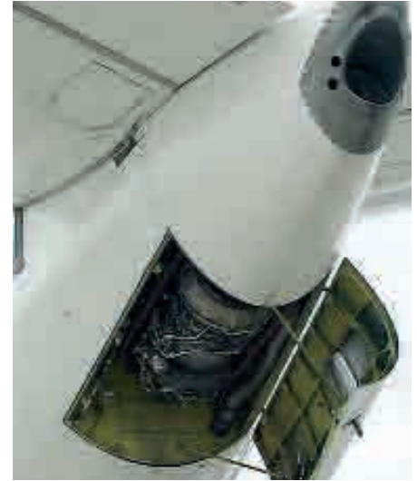
La Auxiliary Power Unit (APU) de un Boeing 737. Capaces de producir hasta 1.450 caballos de potencia, representan alrededor del 20% del total de emisiones de un avión de tamaño medio (Boeing 777) en el aeropuerto.
