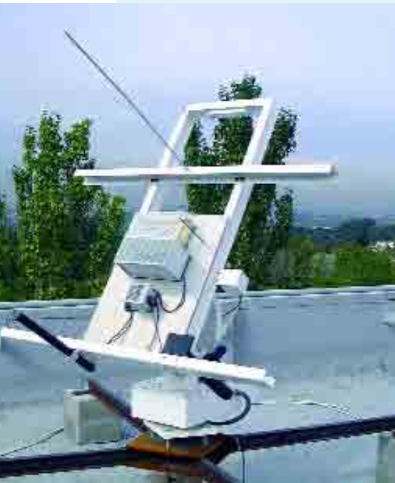
Seguidor solar en dos ejes (tracking) para experimentos de fiabilidad y medida en condiciones reales de los prototipos
