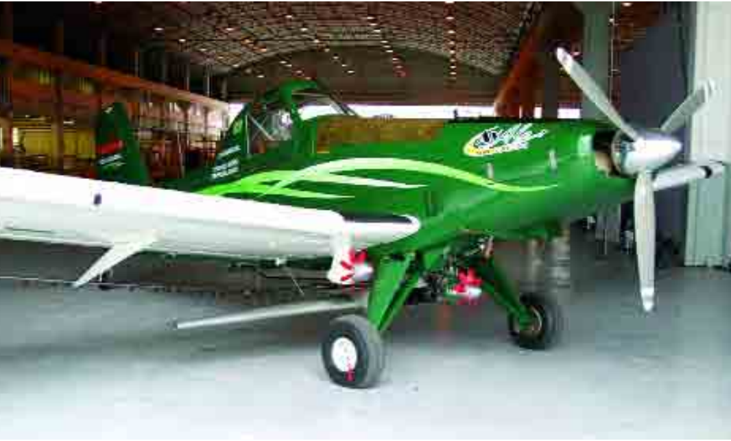
El avión fumigador Ipanema es el primero del mundo que funciona con bioetanol. La aeronave utiliza como combustible etanol elaborado a partir de la caña de azúcar y su utilización para fumigar terrenos agrícolas es un 80% más barata que el modelo que opera con gasolina.
