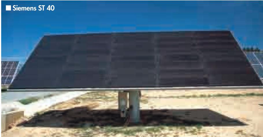
trecha. La relación entre la producción de energía en Oxford y en Mallorca viene a ser del orden del 60 % para la tecnología de banda estrecha; un relación superior a la relación de irradiación anual media. La combinación de buenas prestaciones con bajos niveles de luz y bajas temperaturas de funcionamiento hacen de la tecnología CIS la de mayor rendimiento en la obtención de energía en el Reino Unido.
