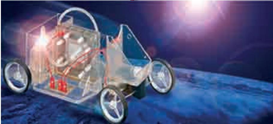
tible. Un pequeño panel solar alimenta la pila, la cual disocia el agua destilada en hidrógeno y oxígeno. Estos dos gases se almacenan en el depósito para su uso posterior. Así que el coche sólo necesita agua destilada y un poco de sol para funcionar. El hidrógeno no se almacena a presión, no hay peligro de explosión.
