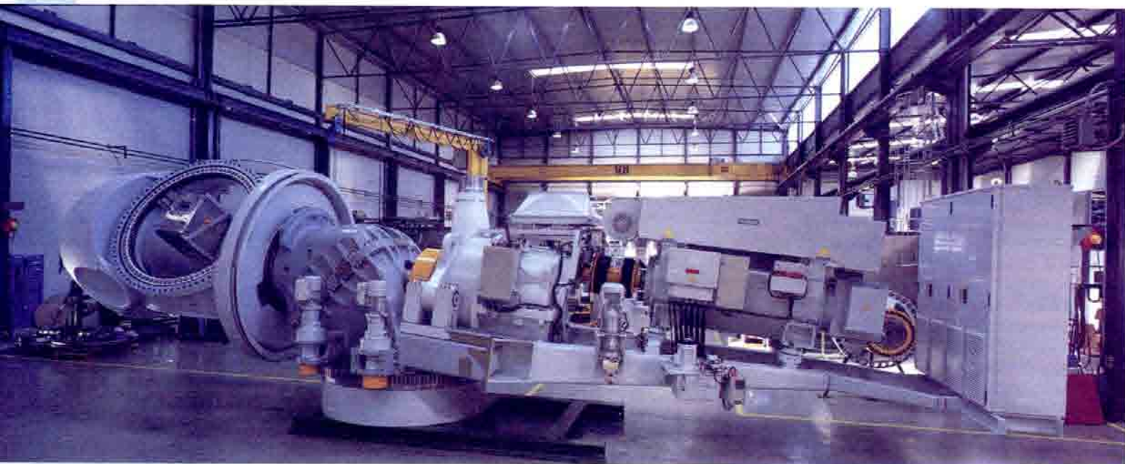
El primer aerogenerador ECOTECNIA 1670, que aquí aparece en la fase de montaje, ya ha sido instalado en Aguilar de Campoo (Palencia). Puede verse que el rotor está soportado por el chasis, que luego desviará los esfuerzos a la torre.
