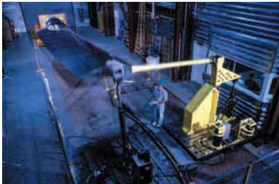
Un técnico somete la pala de un aerogenerador a fuertes tensiones para calibrar su resistencia. Esta prueba es una de las muchas a las que son sometidos los elementos que conforman el aerogenerador para poder garantizar su buen funcionamiento una vez instalados.
