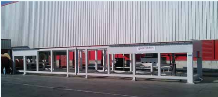
En la página anterior, dos imágenes virtuales de un aerogenerador flotante con un sistema integrado de aprovechamiento de la energía de las olas. Aparece asimismo el logo del proyecto Ocean Líder. Junto a estas líneas, banco de pruebas para cables dinámicos construido por Prysmian.
